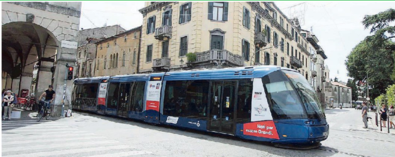
Il tram all'ingresso in Prato della Valle: la prima linea prevede un tratto senza pantografo, esclusivamente con l'uso delle batterie
